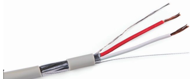
Multiconducteur 22 AWG blindé, 2 conducteurs, 7 brins Disponible en: 500 pi (boîte)/1000 pi (rouleau), riser et plénum Produit no. 22AWG-2C-STR-SH-QQQ-XX-YYYY
