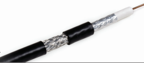
Câble coaxial, RG6, 18 AWG, 60% tressé, coté CMR
