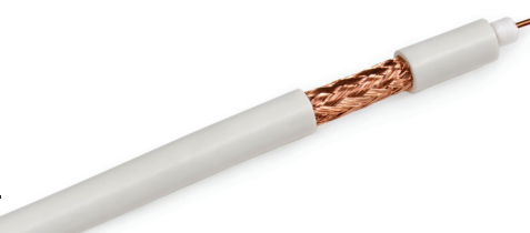
Câble coaxial, RG59/CU, 20 AWG, 95% tressé, coté CMR
