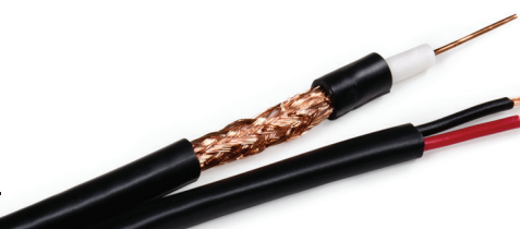
Câble coaxial, RG59/CU, siamois, 95% tressé, 18/2 AWG, coté CMR
